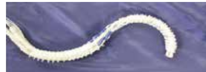
空気圧人工筋を集積した柔軟ロボットアーム Flexible robot arm with multiple pneumatic artificial muscles
