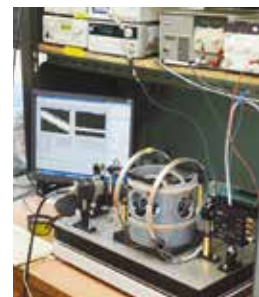
アルカリ金属を用いた光ポンピング磁力計 Optically pumped alkali magnetometer
