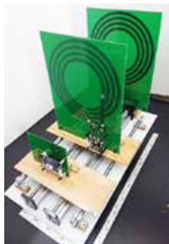
新開発のワイヤレス給電システムの試作機 Prototype of Proposed Wireless Power Transfer System
