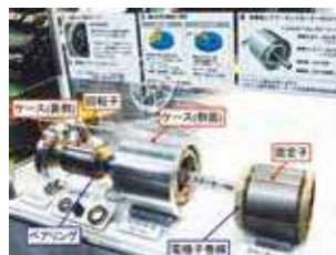
自動車駆動用レアアースレスモータ の開発 Development of rare-earth-less motors for automobile application
