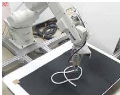
ロボットによるロープのハンドリング実験の様子 Appearance of Rope Handling Experiment with a Robot
